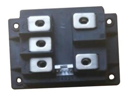
晶闸管的正向漏电流比一般硅二极管反向漏电流大,且随着管子正向阳极电压升高而增大。当阳极电压升到足够大时,会使晶闸管导通,称为正向转折或"硬开通"。多次硬开通会损坏管子。2. 晶闸管加上正向阳极电压后,还必须加上触发电压,并产生足够的触发电流,才能使晶闸管从阻断转为导通。触发电流不够时,管子不会导通,但此时正向漏电流随着增大而增大。晶闸管只能稳定工作在关断和导通两个状态,没有中间状态,具有双稳开关特性。是一种理想的无触点功率开关元件。3. 晶闸管一旦触发导通,门极完全失去控制作用。要关断晶闸管,必须使阳极电流《维持电流,对于电阻负载,只要使管子阳极电压降为零即可。为了保证晶闸管可靠迅速关断,通常在管子阳极电压互降为零后,加上一定时间的反向电压。晶闸管主要特性参数1. 正反向重复峰值电压——额定电压□VDRM□VRRM取其小者)2. 额定通态平均电流IT□AV□——额定电流(正弦半波平均值)3. 门极触发电流IGT□门极触发电压UGT□□受温度变化)4. 通态平均电压UT□AV□即管压降5. 维持电流IH与掣住电流IL6□开通与关断时间晶闸管合格证基本参数IT□AV□=A□
